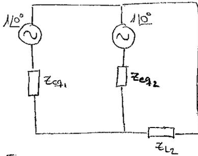
$$\bar{Z}_{eq1} = \bar{Z}_{R1} + \bar{Z}_{cc1} + \bar{Z}_{L1} = 0,3j + (0,03 + 0,298j) + (0,0074 + 0,0222j) = (0,0374 + 0,6202j) = 0,6213 \angle 86,50^\circ$$
